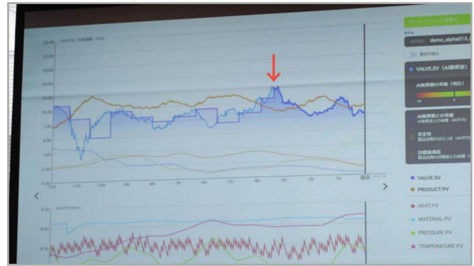
水色の線がAIによる設定の推奨値、紫色の線が実際の運転値を示す。赤い矢印のタイミングで手動運転から自動運転に切り替えている
